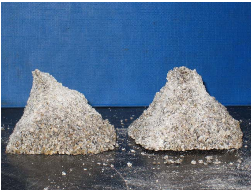
Bild 4: Bruchkörper von UV-beaufschlagten Proben.
