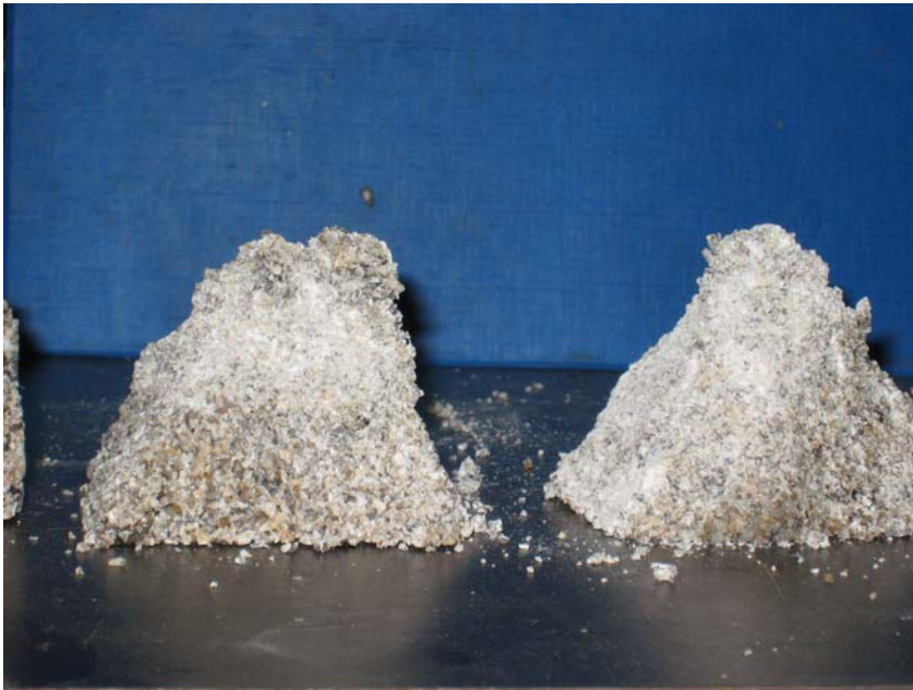
Bild 3: Bruchkörper von Referenz-Proben.
