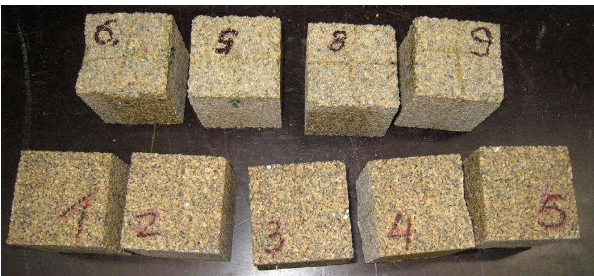
Bild 2: Proben mit UV-Beaufschlagung (obere Reihe: „mit“, untere Reihe: „ohne UV-Schutz“).
